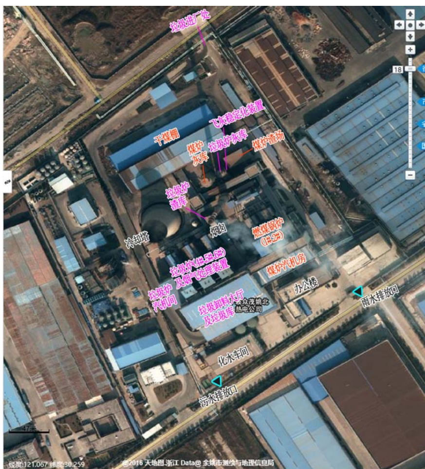
图 3.1-1 现有设施总平面布置示意图
